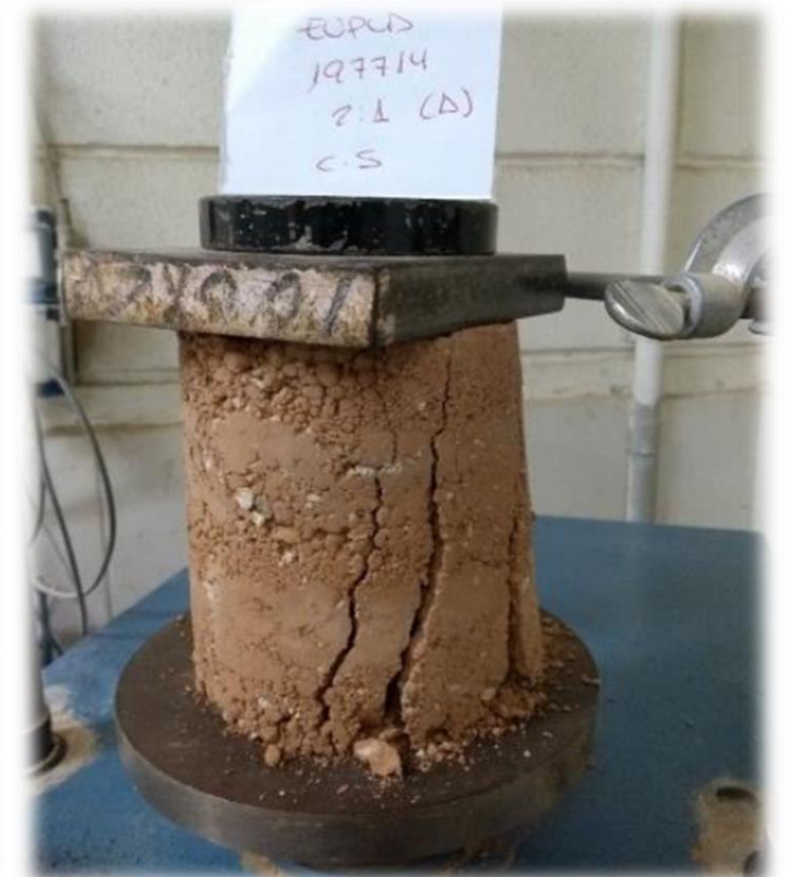
Ensayo de rotura a compresión simple
